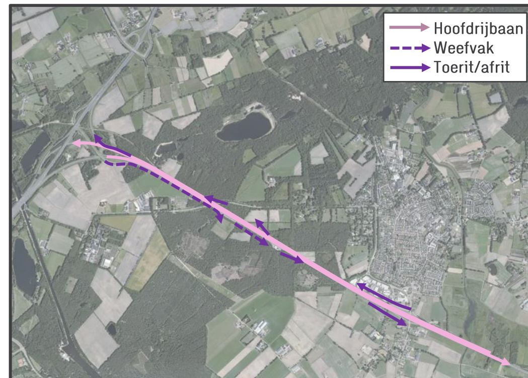
Figuur 16: Overzicht van de huidige op- en afritten langs de A58 tussen Moergestel en knooppunt De Baars
